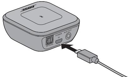
2. A hálózati csatlakozózinór nagyobbik végét csatlakoztassa a hálózati tápegységen lévő csatlakozóhoz.
