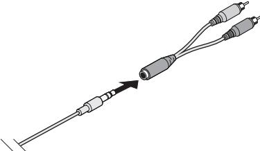
2. Inserire l'altra estremità del cavo audio da 3,5 mm nel connettore **AUX OUT** dell'adattatore audio Bose® Bluetooth®.
