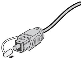
2. 将插头对准适配器上的光纤连接器并小心插入插头。
