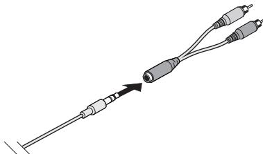
2. Insérez l'autre extrémité du câble audio de 3,5 mm dans le connecteur **AUX OUT** de l'adaptateur audio *Bluetooth*® *Bose*®.
