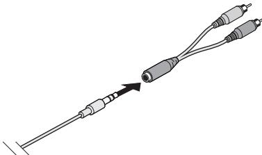
2. 将 3.5 mm 音频线的另一端插入 Bose® 蓝牙® 音频适配器的 **AUX OUT** 连接器。
