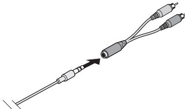
2. Schließen Sie das andere Ende des 3,5-mm-Audiokabels an den Anschluss **AUX OUT** am Bose® Bluetooth® Audio-Adapter an.
