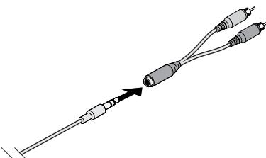
2. เสียบปลายสายด้านหนึ่งของสายเคเบิลสัญญาณเสียง 3.5 มม. เข้ากับช่องเสียบ **AUX OUT** บนอะแดปเตอร์ Bose® Bluetooth® audio
