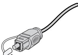
2. Alinee el enchufe con el conector **ÓPTICO** en el adaptador e inserte el enchufe con cuidado.
