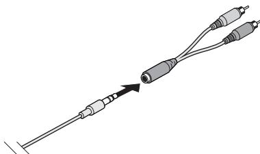
2. Inserte el otro extremo del cable de audio de 3,5 mm en el conector **AUX OUT** del adaptador de audio Bose® *Bluetooth*®.
