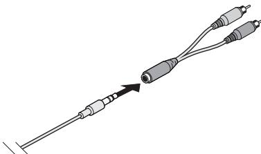
2. 將 3.5 mm 音訊線的另一端插入 Bose® 藍牙® 音訊配接器的 **AUX OUT** 連接器。
