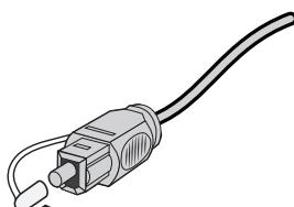
2. Lijn de stekker uit met de aansluiting **OPTICAL** op de adapter en steek de stekker er voorzichtig in.
