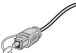
2. Allineare lo spinotto al connettore **OPTICAL** dell'adattatore e inserirlo con cura.
