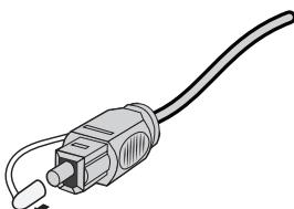
2. Illessze a dugót a rendszer **OPTICAL** jelölésű csatlakozójához, majd óvatosan dugja be.
