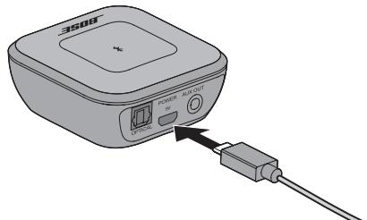
2. Insérez la grande extrémité du cordon d'alimentation dans le connecteur de l'adaptateur secteur.
