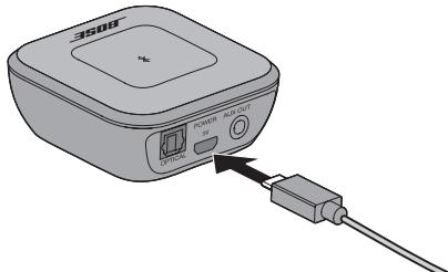
2. 將電源線的較大端插入交流電源連接器。
