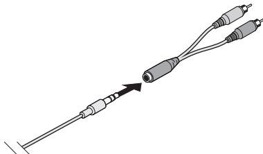
2. Dugja be a 3,5 mm-es audiokábel egyik végét az **AUX OUT** jelzésű csatlakozóba, amelyet a Bose® Bluetooth® audio adapteren talál.
