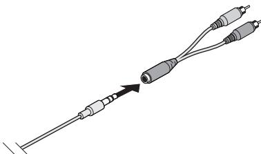
2. Sluit het andere uiteinde van de audiokabel van 3,5 mm aan op de aansluiting **AUX OUT** op de Bose® Bluetooth®-audioadapter.
