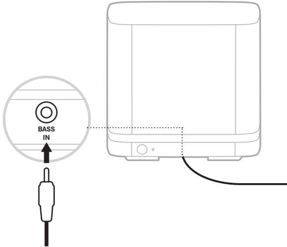
2. Tilslut den anden ende af kablet til BASS-stikket bag på soundbaren eller højttaleren.
