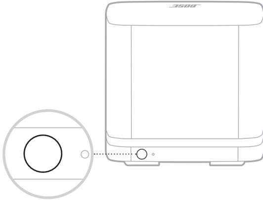
Når bassmodulen kobles til lydplanken på nytt, spilles det av en tone og lampen på baksiden av bassmodulen lyser hvitt.
