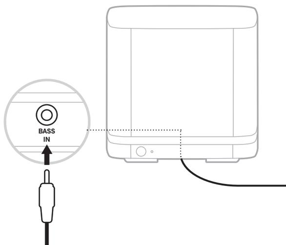
2. Podłącz drugą wtyczkę przewodu do złącza BASS na tylnym panelu zestawu soundbar lub głośnika.
