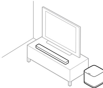
**LET OP:** Plaats de basmodule NIET op zijn bovenkant of zijkant wanneer deze in gebruik is.
