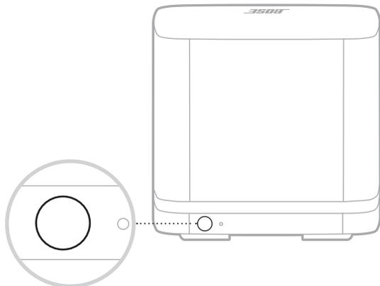
ベースモジュールとサウンドバーが再度接続されると、ピープ音が聞こえ、ベースモジュールの背面にあるインジケータが白に点灯します。
