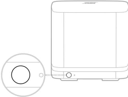
Quando il modulo bassi si ricollega alla soundbar, si attiva un segnale acustico e la spia posta sul retro del modulo bassi si illumina in bianco.
