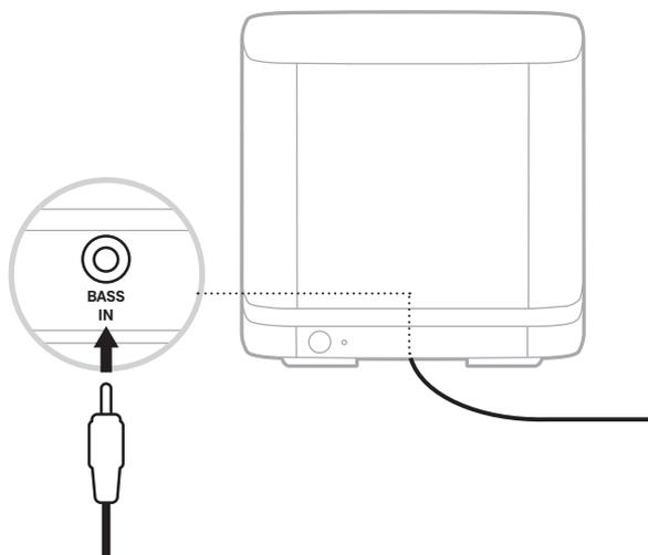
2. 将连接线另一端连接至条形音箱或扬声器背面的 **BASS** 连接器。
