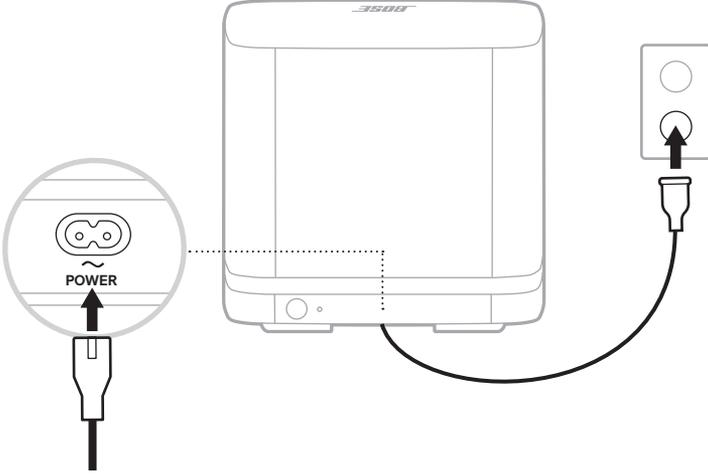
2. أدخل الطرف الآخر لسلك الكهرباء في مأخذ التيار المتردد (الرئيسي).
