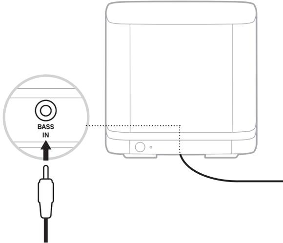
2. เชื่อมต่อปลายสายอีกด้านหนึ่งเข้ากับช่องเสียบ BASS ที่ด้านหลังของ Soundbar หรือลำโพง
