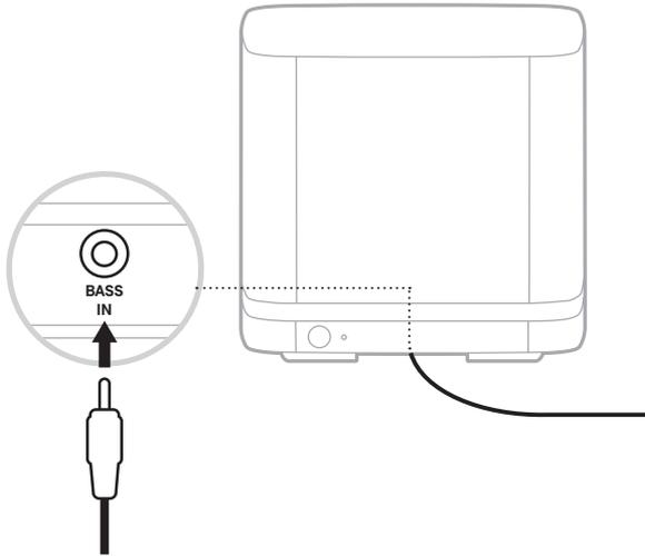
2. A kábel másik végét csatlakoztassa a hangsugárzó vagy a hangszóró hátoldalán lévő BASS csatlakozóba.
