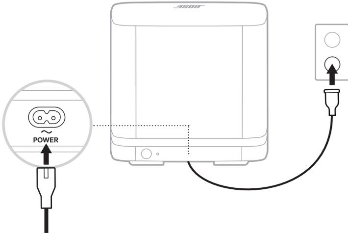
2. 電源コードの反対側を、壁のコンセントに差し込みます。
