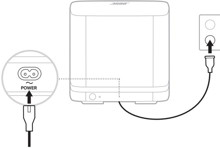
2. เสียบปลั๊กอีกด้านของสายไฟเข้ากับเต้ารับไฟฟ้า AC (สายเมน)
