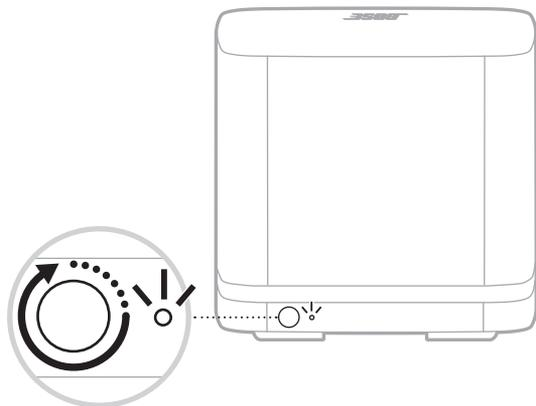
リセットが完了すると、インジケータがオレンジ色に点滅します。
