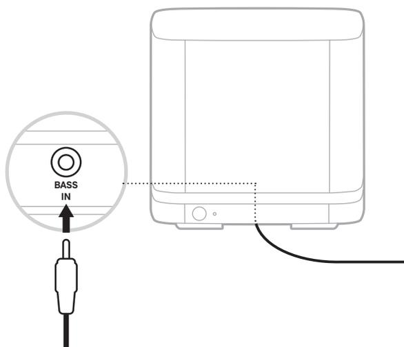
2. Conecte a outra extremidade do cabo ao conector BASS na parte de trás da barra de som ou do alto-falante.
