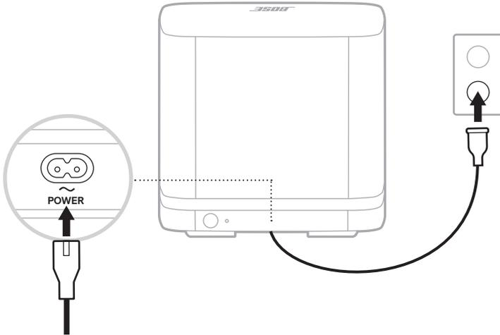
2. Schließen Sie den anderen Stecker des Netzkabels an eine Netzsteckdose an.
