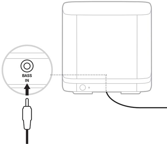
2. Sluit het andere uiteinde van de kabel aan op de aansluiting **BASS** aan de achterkant van de soundbar of luidspreker.
