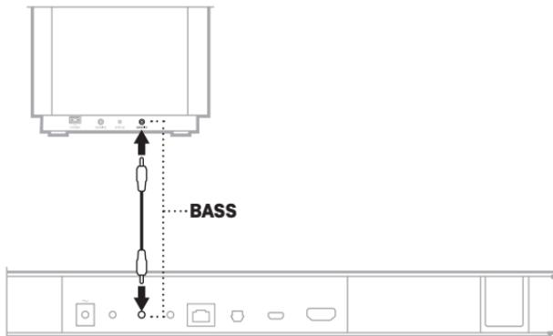
ベースモジュールの **BASS IN** 端子とサウンドバー、スピーカー、またはアンプの **BASS** 端子を 3.5 mm ステレオ音声ケーブルで接続します。
