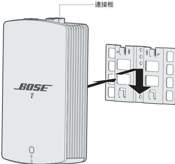
2. 輕輕向下推放大器到架子的翼片上，直到放大器卡到位。
