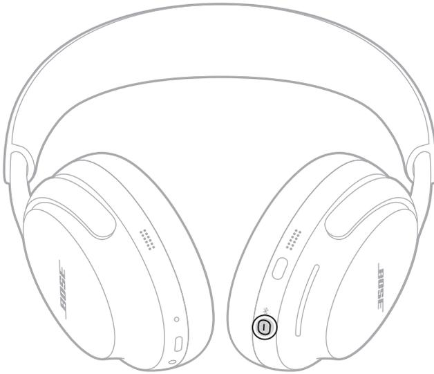
Dopo qualche secondo, si sente un segnale acustico e un messaggio vocale annuncia il livello della batteria. L'indicatore di stato si illumina in base al livello di carica corrente (vedere pagina 38).
