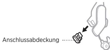
5. Richten Sie die Freigabetaste an der linken Seite mit der Freigabetastenöffnung aus und stecken Sie die Anschlussabdeckung unten in die Anschlussbuchse.
