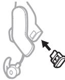
6. Insérez le capot du protège-borne dans l'embase de connecteur jusqu'à ce que le bouton de déblocage soit protégé.
