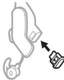
6. Schieben Sie die Anschlussabdeckung in die Anschlussbuchse, bis die Freigabetaste fest ist.
