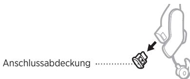
5. Richten Sie die Freigabetaste an der linken Seite mit der Freigabetastenöffnung aus und stecken Sie die Anschlussabdeckung unten in die Anschlussbuchse.
