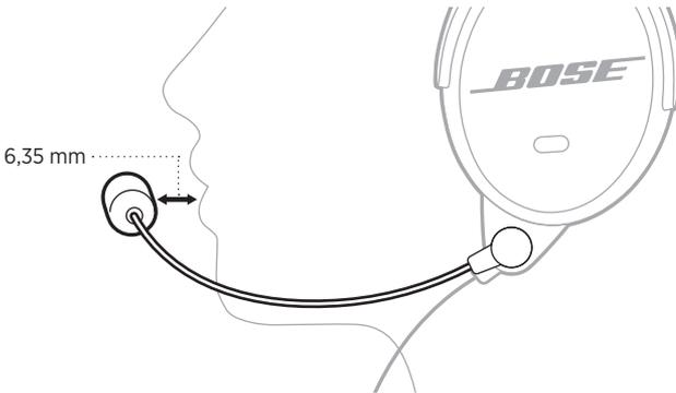
**ATTENZIONE:** il microfono può ruotare fino a 320°. Per evitare danni, NON forzare la rotazione del microfono oltre l'angolazione prevista.
