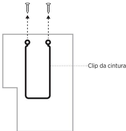
2. Appoggiare la staffa sul gruppo radio/trasmittitore da cintura allineando i fori per le viti.
