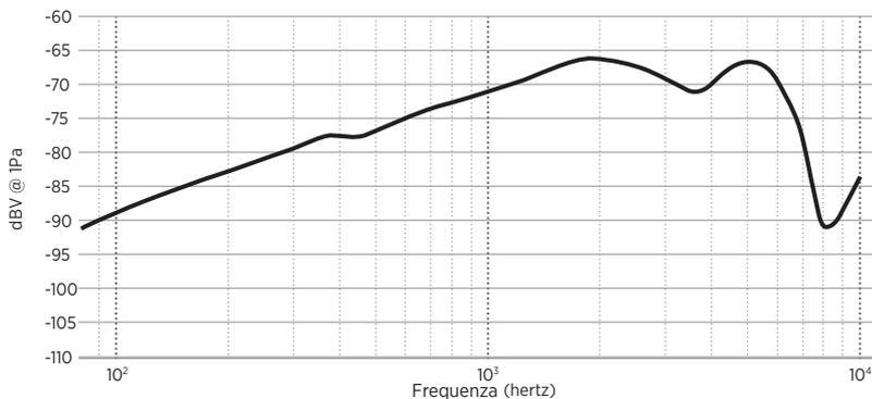
Sensibilità del microfono: -71 dBV/Pa a 1 kHz\*
