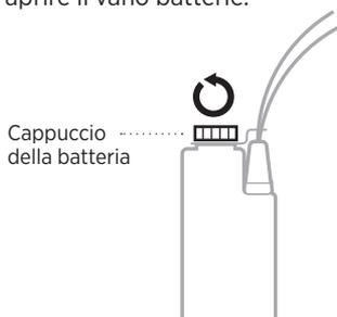
2. Inserire nel vano le due batterie alcaline AA. Fare combaciare i simboli + e – sulle batterie con i segni + e – sul modulo di controllo.
