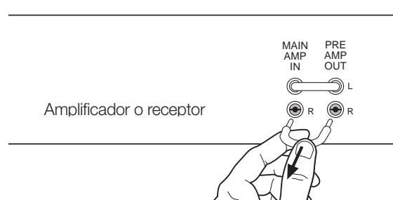
2. Utilice los cables bifilares (con dos conectores en cada extremo) que se suministran con el ecualizador. Utilice un color para las conexiones del canal derecho (R) y el otro color para las conexiones del canal izquierdo (L).
