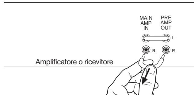
2. Utilizzzi la piattina (con due connettori ad ogni estremità) fornita con l'equalizzatore. Usi un colore per i collegamenti del canale destro (R) e l'altro colore per i collegamenti del canale sinistro (L).
