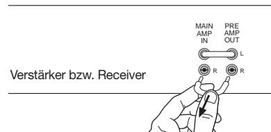
2. Verwenden Sie die zusammen mit dem Equalizer gelieferten Zwillingskabel (mit zwei Steckverbindungen an jedem Ende). Verwenden Sie einen Anschluß für den rechten Kanal (R) und die andere Farbe für den linken Kanal (L).
