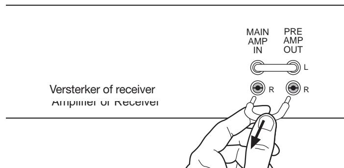
2. Gebruik de dubbele kabelmontages (met de twee connectors aan elk uiteinde) die bij de equalizer worden geleverd. Gebruik een kleur voor de rechter (R) kanaalaansluitingen en de andere kleur voor de linker (L).
