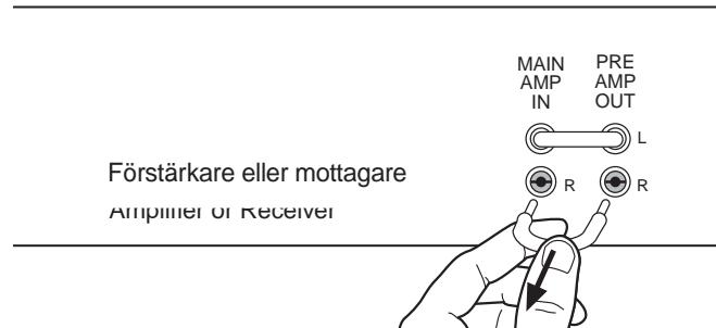
2. Använd de dubbla kabelenheterna (med två kontakter i varje ände) som medföljer utjämnaren. Använd en färg för de högra (R) kanalanslutningarna och den andra färgen för de vänstra (L) kanalanslutningarna.
