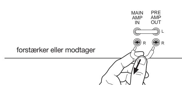
2. Brug samlingerne med tvillingekablerne (med to stik for hver ende), som kom med equalizeren. Brug den ene farve til højre (R) kanalstilslutninger, og den anden farve til venstre (L) kanalstilslutninger.
