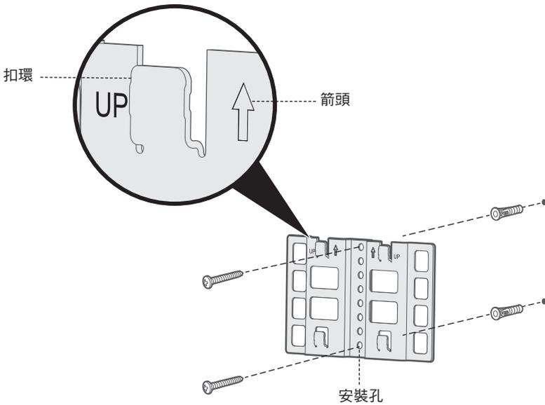
2. 透過安裝架的安裝孔在牆上標記頂部和底部安裝孔的位置。
