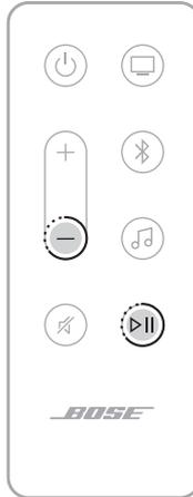
Die Soundbar wird neu gestartet. Wenn das Zurücksetzen abgeschlossen ist, leuchtet die Lichtleiste gelb.
