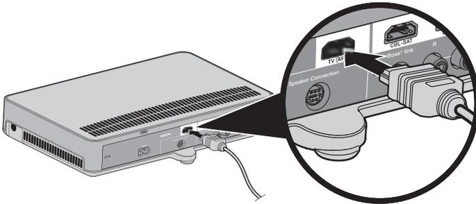
3. 將 HDMI 線纜的另一端插入電視的 **HDMI (ARC)** 連接器。
