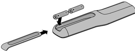
2. Inserte las dos baterías AA (IEC-LR6) 1.5V suministradas. Haga coincidir los símbolos + y - de las baterías con las marcas + y - dentro del compartimento.
