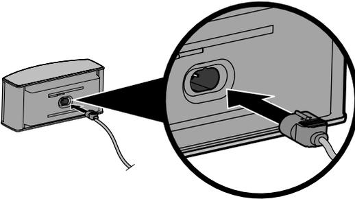
3. Conecte el enchufe **R** del cable del altavoz delantero en la parte derecha del televisor.
