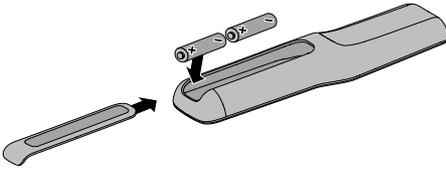
2. Insérez les deux piles AA (IEC-LR6) 1,5 V fournies. Faites correspondre les symboles + et – des piles avec les repères + et – situés à l'intérieur du compartiment.
