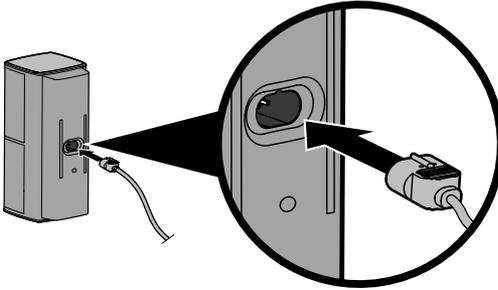
2. Insérez la fiche du câble de l'enceinte avant **C** dans l'enceinte centrale.
