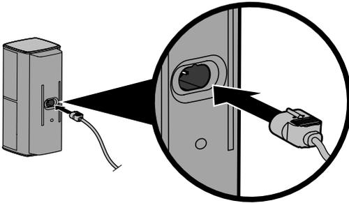
2. Insérez la fiche du câble de l'enceinte arrière **RR** dans l'enceinte arrière droite.
