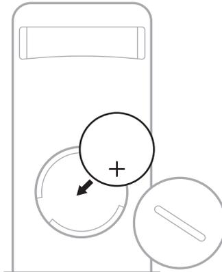
**備註：**更換電池時，只能使用機構認可的（如 UL）CR2032 或 DL2032 等 3 伏鋰電池。
