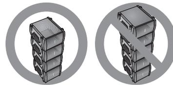
**⚠ PRECAUCIÓN:** No conecte más de dos módulos de graves B1 al conector de salida del módulo de graves del pedestal. Si suministra alimentación a más de dos módulos de graves B1 desde esta salida, se sobrecargará el amplificador del pedestal y se verá afectado el rendimiento del sistema.
