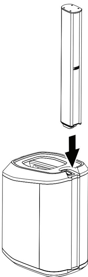
L'unità L1 Pro8/Pro16 può essere assemblata senza utilizzare l'estensore per array; l'array mid-high può essere collegato direttamente alla base di alimentazione. Questa configurazione è particolarmente utile su palchi elevati, per avere la certezza che l'array mid-high si trovi all'altezza delle orecchie.
