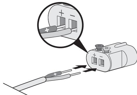
**注意：**確保僅插入每條外露電線的裸露部分，避免夾住電線的絕緣層。
