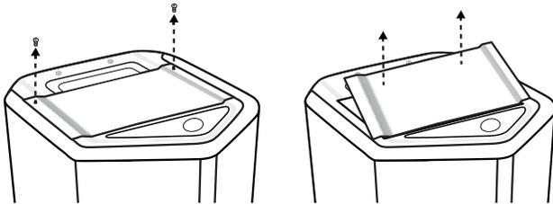
3. Rimuovi la batteria utilizzando le linguette.
