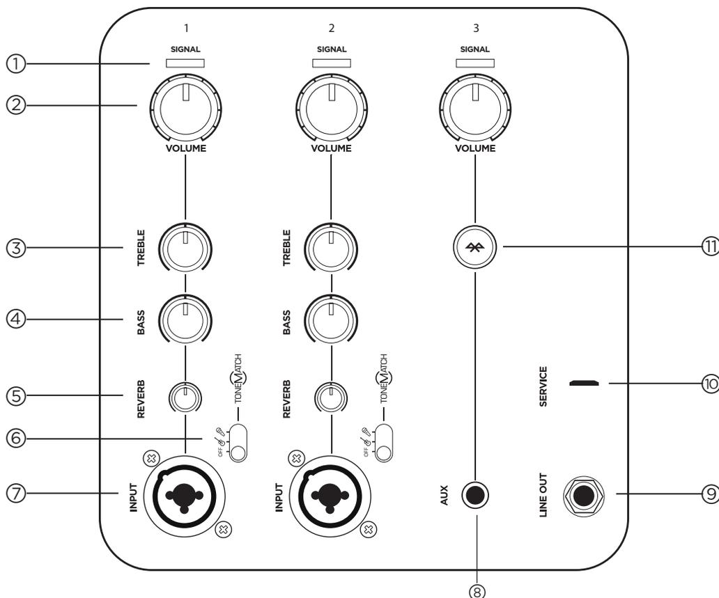
Utilizza gli ingressi dei canali 1 e 2 per collegare microfoni e strumenti musicali. L'elaborazione del segnale ToneMatch® integrata consente a microfoni e strumenti di avere la migliore timbrica possibile. Utilizza il canale 3 per la connettività Bluetooth® e per ingressi line.
