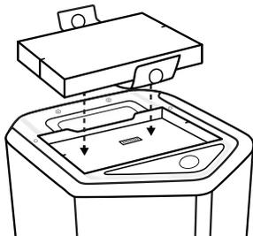
5. Posiziona nuovamente la piastra inferiore e fissala con le due viti rimosse nel passaggio 2.
