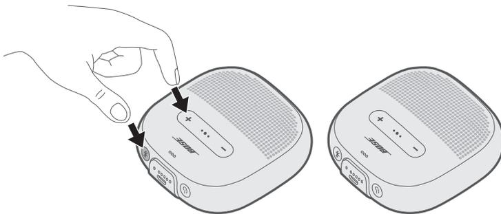
4. 「2つ目のボーズのデバイスでBluetooth ボタンと音量ダウンボタンを同時に押します」と聞こえたらボタンを放します。
