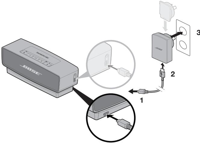
2. 電源コードのもう一端を、電源アダプターに接続します。
