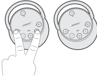
4. 聽到「Press the *Bluetooth* and volume down buttons simultaneously on a second Bose device (同時按下第二台 Bose 裝置的上 *Bluetooth* 和音量下調按鈕)」時，放開按鈕。
