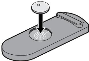
3. Vuelva a ajustar la tapa y gírela en sentido de las agujas del reloj hasta que encaje.
