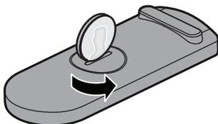
2. Retirez le couvercle. Présentez la nouvelle pile côté plat vers le haut, avec le symbole + apparent.
