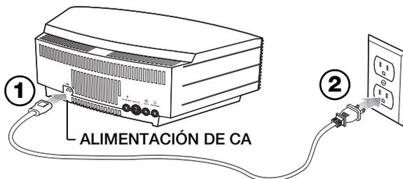
3. Desenrolle y estire el cable de alimentación para asegurar la mejor recepción de radio FM. El cable de alimentación sirve de antena.
