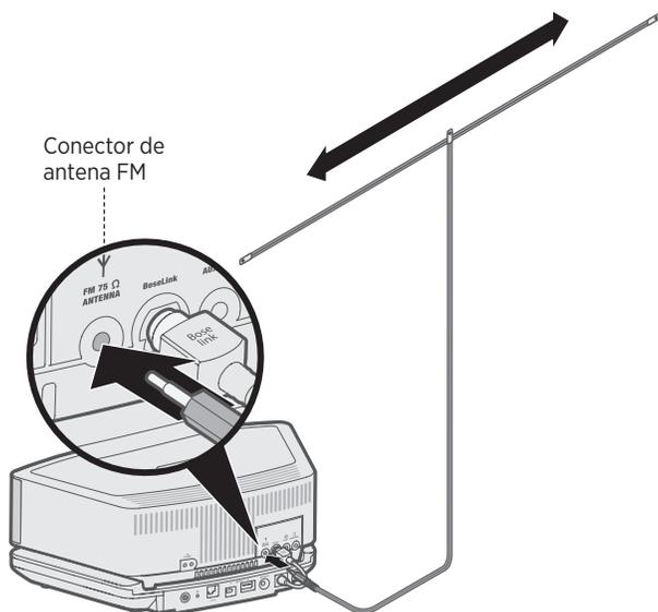
**Nota:** Muchas estaciones de radio FM transmiten señales verticalmente polarizadas así como señales horizontalmente polarizadas o una de éstas. Si la orientación de la antena horizontal no ofrece una buena recepción, intente colgar la antena en posición vertical.
