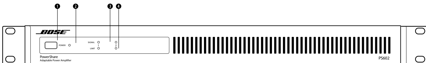
図2.PowerShare PS602のフロントパネル
