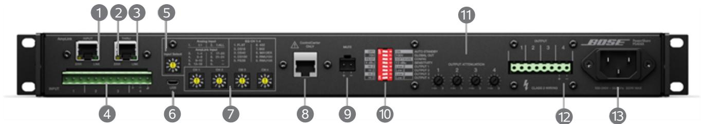
**1 AmpLink** – RJ-45 接口，最多能够接收来自 Bose AmpLink 产品的 24 个数字通道。该款功放还支持通过 THRU 环出接口将全部 24 个数字音频通道连接成菊花链结构并与其它 Bose AmpLink 产品连接，产品之间的最大间距为 10 米。
