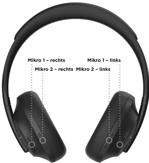
Duales Mikrofonarray mit Richtmikrofontechnologie
