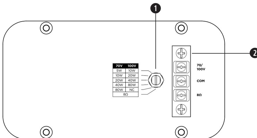
❶ 抽头开关：旋转可调整抽头设置。使用一字螺丝刀。
