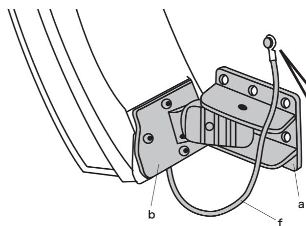
壁面取付プレート(パート一覧:a)に印刷されている角度表示から希望する方向に502Aを合わせ、手順4、5で差し込んでいる8mmボルト/ナット(パート一覧:d)と、6mmボルト/ナット(パート一覧:e)を締め上げ固定します。
