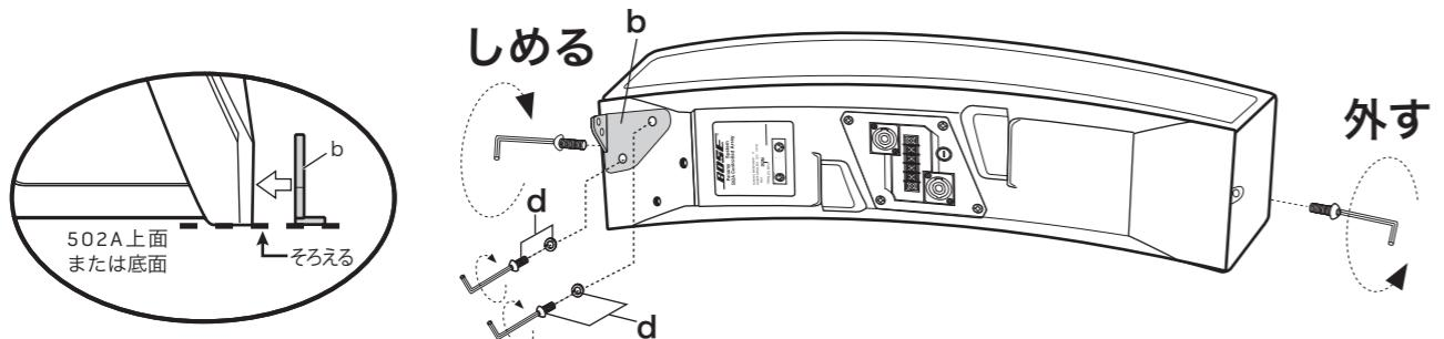
**2** 付属の8mmボルト(長さ12mm/パート一覧:d)を使って、安全ケーブル(パート一覧:f)の一端を金具取付用埋込穴ナットのうち未使用のどちらかのナットに取り付けます。
