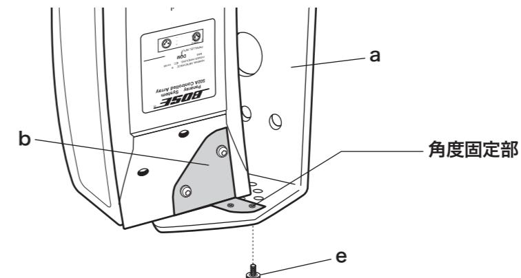
**7** 手順5で仮止めしておいた、付属の8mmボルト(長さ20mm/パート一覧:c)を完全に締め付けます。
