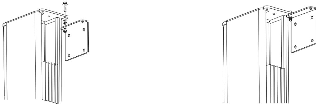
5. 将整个扬声器阵列（1 到 3 个模块）悬挂在顶部支架上。确保固定在扬声器支架上的法兰螺栓完全插入到壁挂支架的隙孔中。将法兰螺母套上螺栓，用手拧紧，略可松动，使扬声器可以旋转 90 度。
