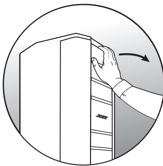
De array naar buiten trekken
