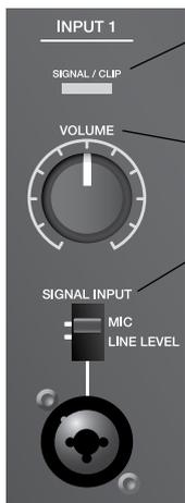
「**SIGNAL/CLIP**」(シグナル/クリップ): 入力信号の状態を色で表示します。
