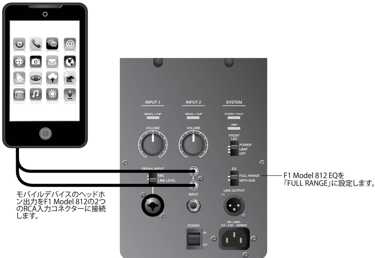
モバイルデバイスをF1 Model 812 LoudspeakerとF1 Subwooferに接続
