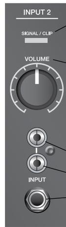
「**SIGNAL/CLIP**」(シグナル/クリップ): 入力信号の状態を色で表示します。
