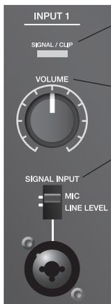
**信号 / 削波：**彩色灯显示输入信号状态。
