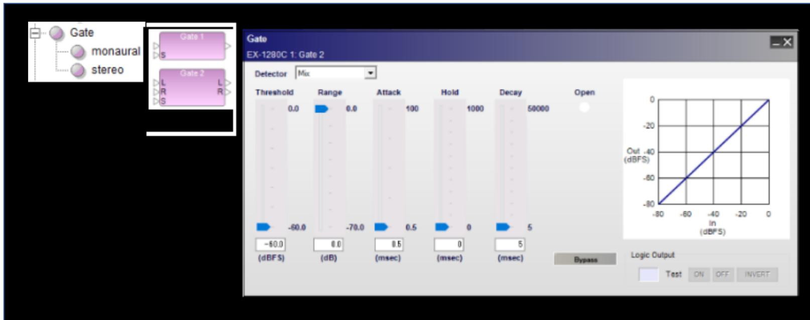
Threshold、Range、Attack、Hold、Decay を調整するには左側の 5 本のスライダーをそれぞれ使用します。コントロールパネル右側のグラフは、入出力信号のレベルの関係を示し、線は Gate の効果を示します。どの入力をトリガーソースに使用するかを Detector ドロップダウンメニューで選択します。L・R 両方の入力をトリガーソースとして使用する場合にはステレオ Gate (stereo) モジュールで Mix を選択します。Bypass ボタンをクリックすると、Gate はバイパスされます。
