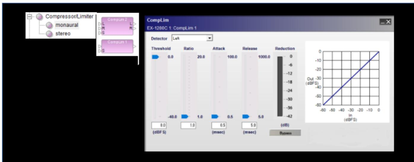
**Detector** - どの信号をトリガーとして機能するかを設定します。
