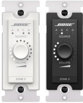
ControlCenterデジタルゾーンコントローラーは、一連の壁付け用ボリュームコントローラー&ソースセレクター(以下CC-xDシリーズ)です。CC-1Dはシングルソースコントローラー、CC-2Dは2ソース、CC-3Dは4ソースコントローラーです。ブラックとホワイトがあり、Cat5e以上のケーブル(RJ45)端子で接続します。(電工プレート等については、アナログコントローラCC-1/2/3のページをご参照ください。)
