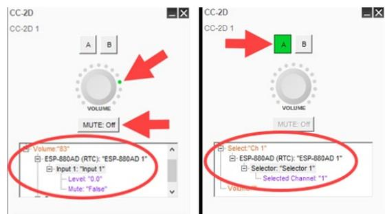
シグナルプロセッシングビュー内から各ツリーに任意のブロックをドラッグアンドドロップすることにより、ボリューム・ミュート、セレクターやソースボタン(Selector, Parameter Setなど)としてプログラムできます。また、シミュレータ上で動作することで、事前のシミュレーションとして確認することができます。
