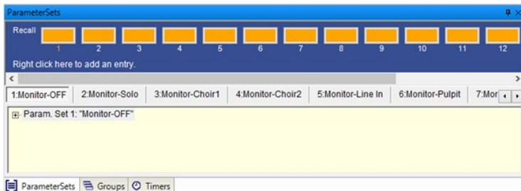
Parameter Setsには、選択したシグナルプロセッサの設定と値が保存されます。これらは、後でGPIやコントロールセンターなどの外部トリガーを使用して手動で呼び出すことも、Timerによって呼び出すこともできます。
