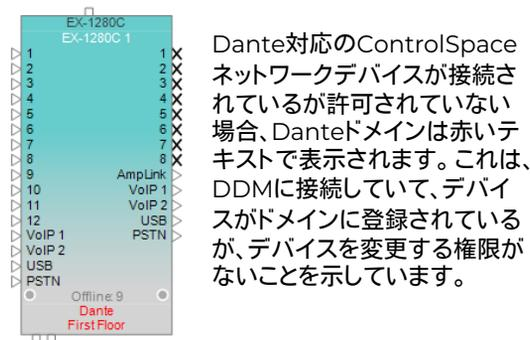
Dante対応のControlSpaceネットワークデバイスが接続されているが許可されていない場合、Danteドメインは赤いテキストで表示されます。これは、DDMに接続していて、デバイスがドメインに登録されているが、デバイスを変更する権限がないことを示しています。
