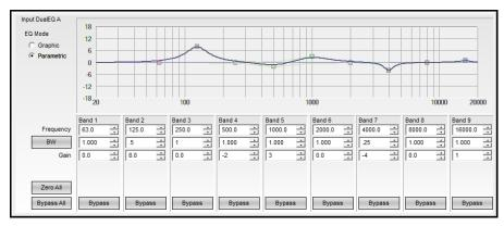
Fig. 3.5- Parametric EQ Mode
