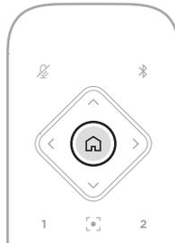
Para que la cámara vuelva a la configuración predeterminada de paneo, inclinación y zoom, presione el botón **Inicio** en el control remoto.
