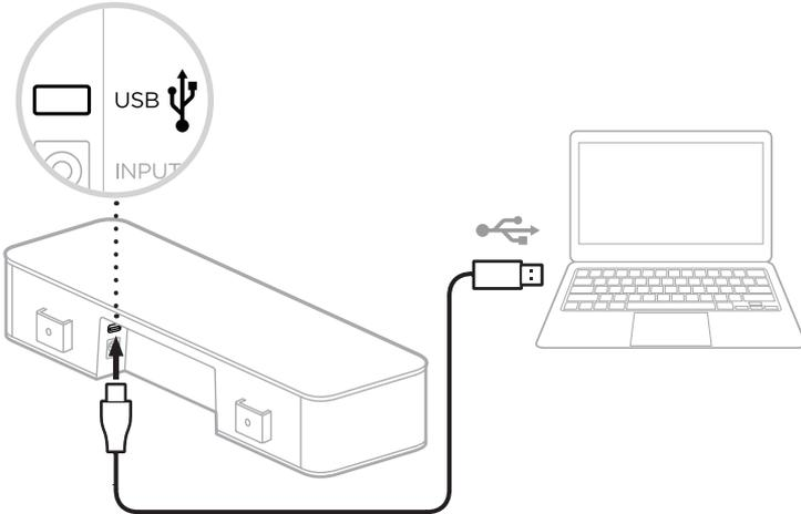
3 استخدم سلك التغذية الكهربائية المرفق لتوصيل VB-S بأخذ طاقة. انتظر حتى يتم تشغيل VB-S.
